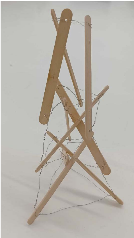
試作品(試作のため引張材に針金を使用)
