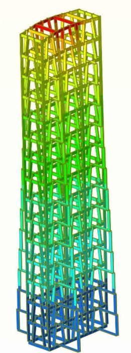
簡易モデルによる静的解析による変位量の確認 上部の変位は両方向とも約 30cmとなっている。
