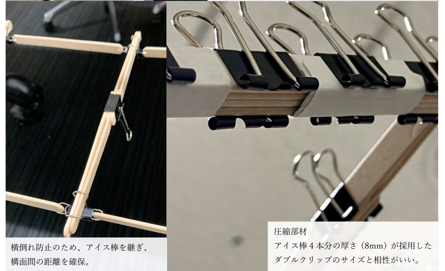
引張部材の接合部 ゼムクリップとダブルクリップを利用し、 材軸方向とその直交方向の横繋ぎを美しく両立させる。
